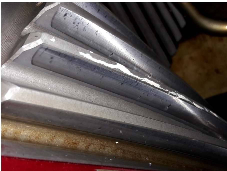
Imagem 5: Região da retirada de impressões das superfícies da turbina eólica UDV01-14 depois da aplicação
