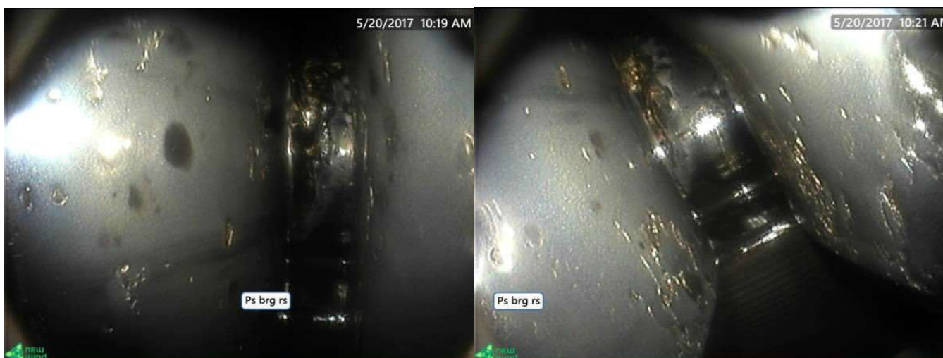
Imagens 14 e 15: Pista interna e elemento rodante do rolamento – lado do gerador, depois do tratamento
