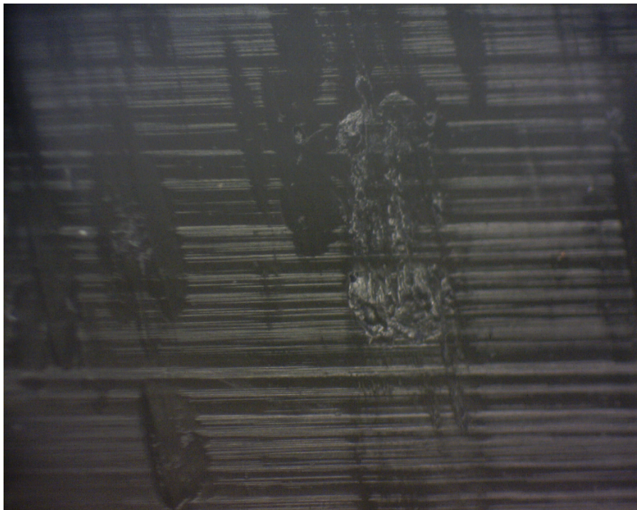
Imagem 6: Impressão da superfície antes da aplicação no gearbox da turbina eólica nº 01-14
