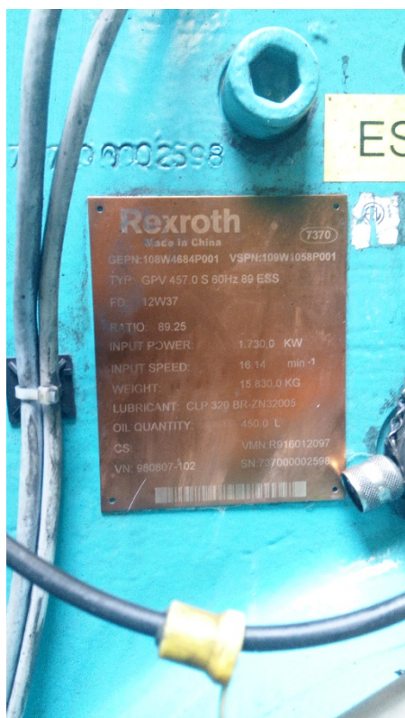
Imagem 2: placa de identificação do gearbox Rexroth
