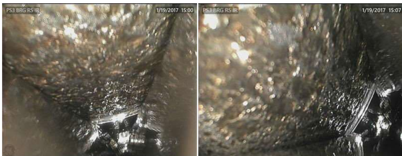
Imagens 12 e 13: Pista interna e elemento rodante do rolamento – lado do gerador, antes do tratamento
